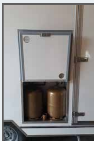
Trappe d'accès extérieur au caisson pour 2 bouteilles de gaz propane
