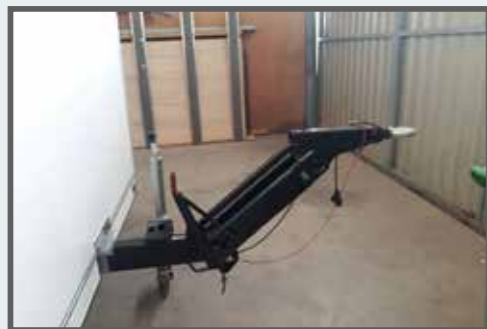
Attelage par anneau avec timon articulé pour une adaptation à tout type de véhicule
